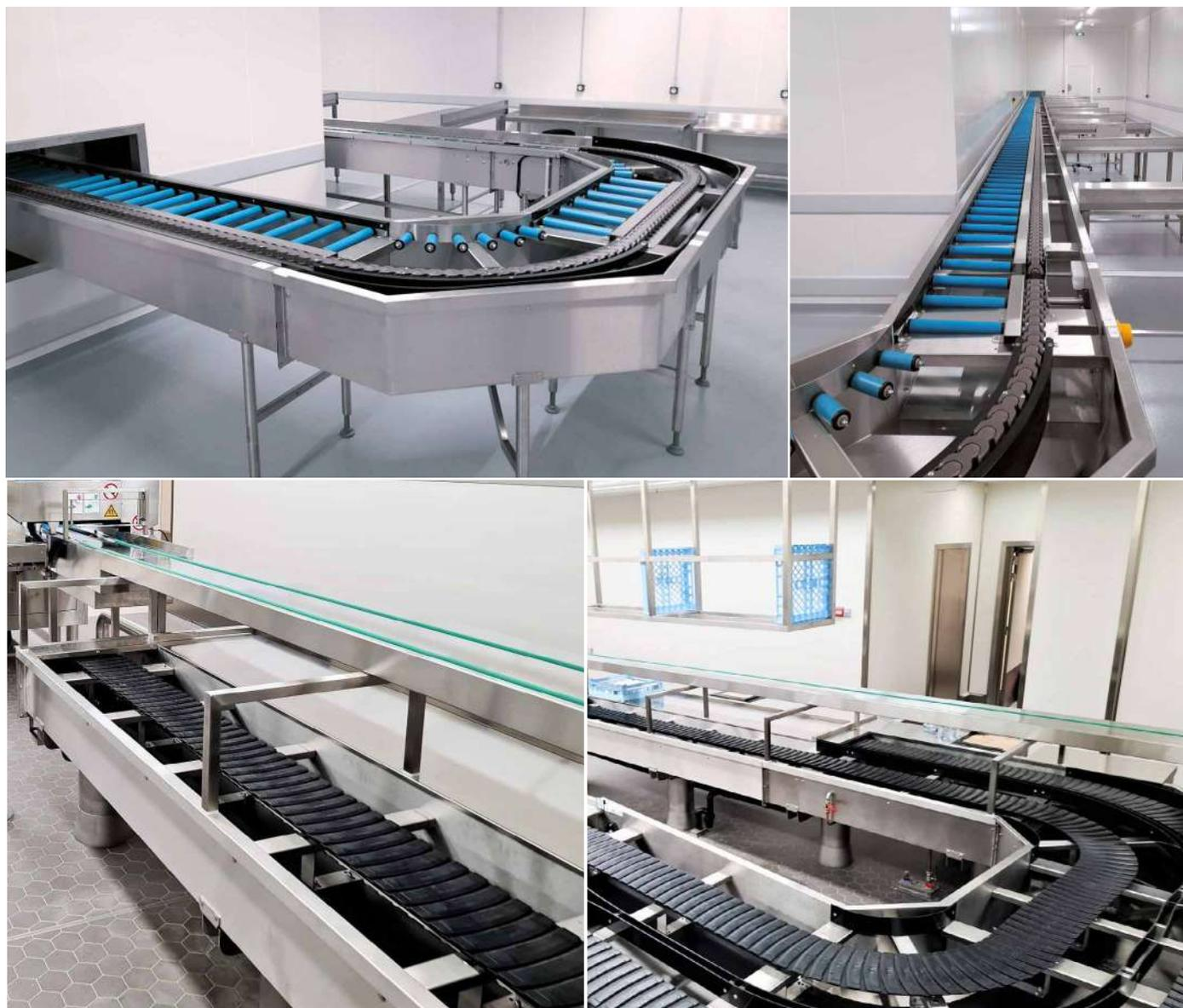
Notre système de transport bi-cordes personnalisé est la solution parfaite pour optimiser non seulement le transport, mais aussi le lavage et le retour des plateaux. Ces derniers sont parfaitement séchés et prêts à être utilisés, sans besoin d'intervention de l'opérateur, tout ceci, en con-
