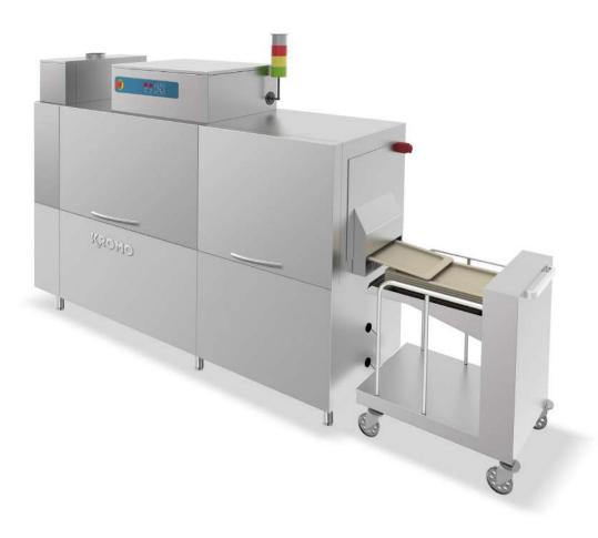
Il recuperatore termico di serie utilizza i vapori prodotti dalla macchina per preriscaldare l'acqua fredda di alimentazione, con un immediato risparmio di risorse. Le speciali corde di trascinamento, inclinate e divise per zona, evitano contaminazioni tra moduli e facilitano la speciale asciugatura a
