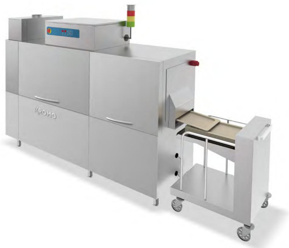
Il recuperatore termico di serie utilizza i vapori prodotti dalla macchina per preriscaldare l'acqua fredda di alimentazione, con un immediato risparmio di risorse. Le speciali corde di trascinamento, inclinate e divise per zona, evitano contaminazioni tra moduli e facilitano la speciale asciugatura a
